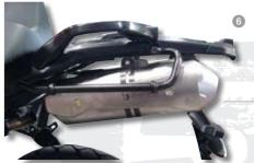
6 Akrapoviĉ Slip-on Muffler Akrapoviĉ titanium coated, street legal, slip-on, dual exhaust system. 11D-W0769-00-00
